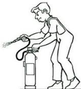
4.- Dirigir el chorro a la base de las llamas con movimiento de barrido. En caso de incendio de líquidos proyectar superficialmente el agente extintor efectuando un barrido evitando que la propia presión de impulsión provoque derrame del líquido incendiado. Aproximarse lentamente al fuego hasta un máximo aproximado de un metro.
